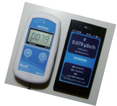
計測機モニター HORIBA Radi (左)。時刻と測定データを10秒単位でスマートフォンにBluetoothで送信し、スマホの位置情報と合わせて記録。データはメールでPCに。
