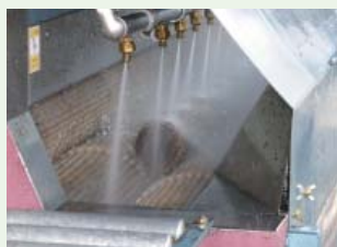
原木除染機。高圧の水とブラシで表面を除染します。
