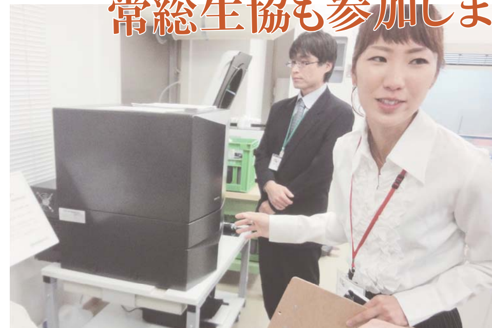
ストロンチウム・トリチウムのベータ線を測定するフィンランド製の液体シンチレーションカウンター(黒)
