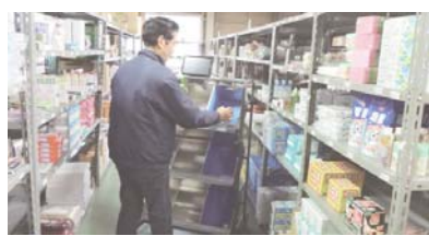
←新センターが稼働する前に、仮倉庫で同じレイアウトでドライ品のマルチピッキングシステム(※)の稼働試験。
