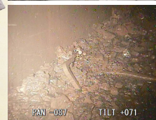
←東京電力福島第1原発2号機の原子炉格納容器底部に落下した燃料デブリと思われる堆積物＝2018/1/19、国際廃炉研究開発機構（IRID）提供
